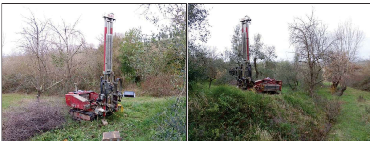
Fig 4: Prova penetrometrica statica con punta elettrica (CPTe) CPTe 08
