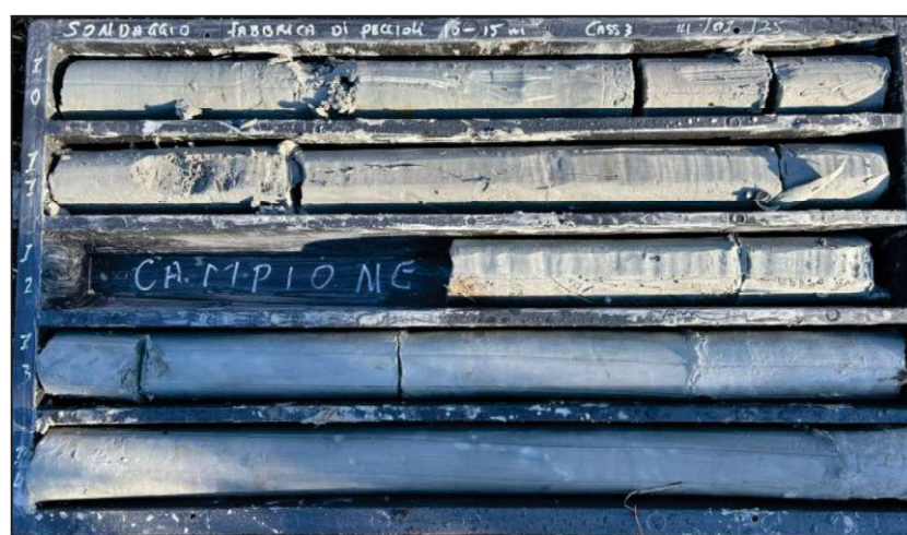
Figura 4: Sondaggio S2 - Cassetta n.3 da 10.00 a 15.00 metri
