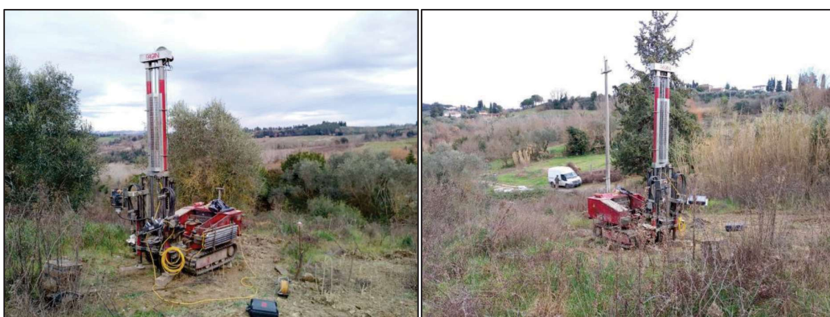
Fig 11: Prova penetrometrica statica con punta elettrica (CPTe) CPTe 23
