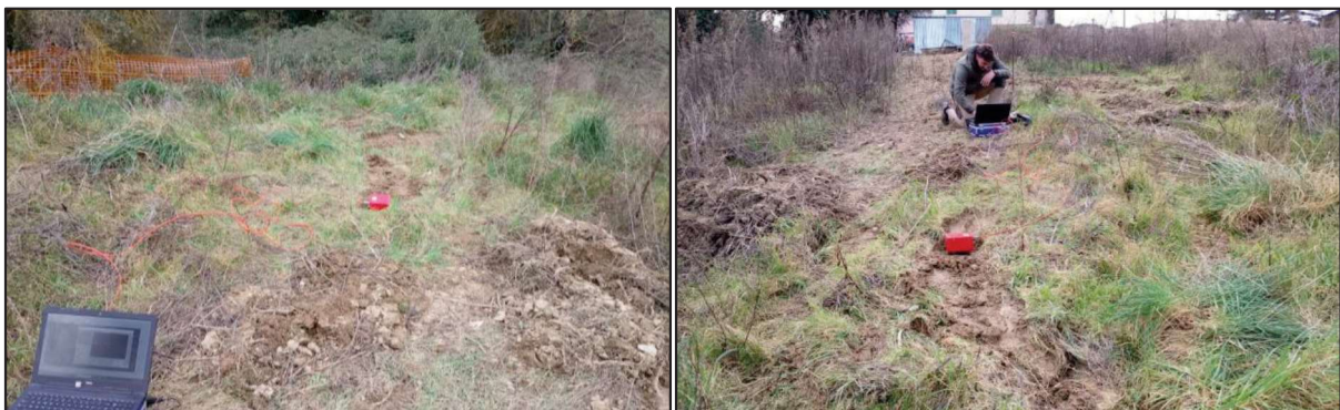
Fig 16: Postazione misura di rumore sismico ambientale a stazione singola HVSR 4
