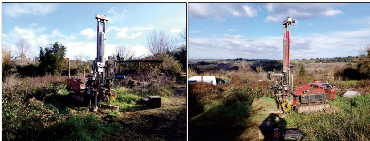
Fig 9: Prova penetrometrica statica con punta elettrica (CPTe) CPTe 20
