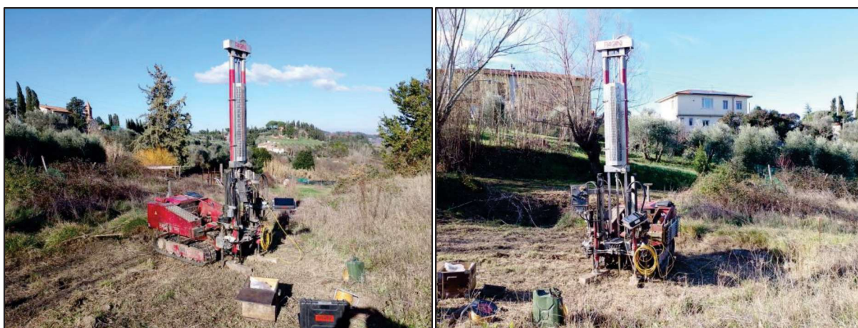
Fig 8: Prova penetrometrica statica con punta elettrica (CPTe) CPTe 18
