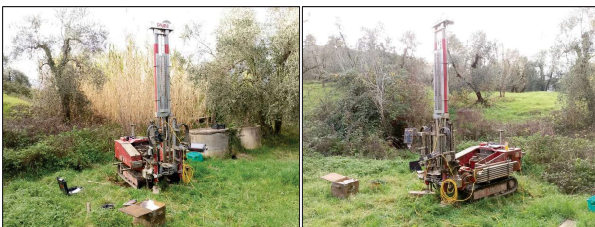
Fig 5: Prova penetrometrica statica con punta elettrica (CPTe) CPTe 10
