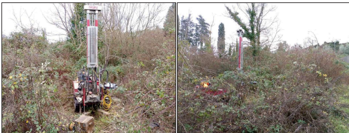
Fig 3: Prova penetrometrica statica con punta elettrica (CPTe) CPTe 05b
