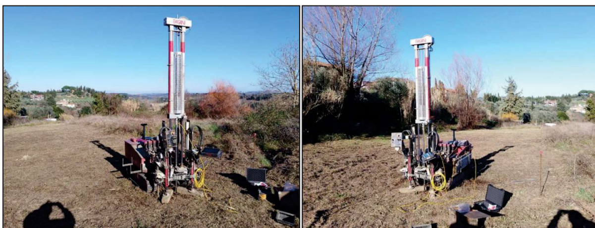
Fig 7: Prova penetrometrica statica con punta elettrica (CPTe) CPTe 16
