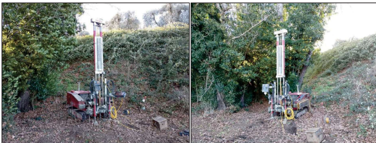
Fig 6: Prova penetrometrica statica con punta elettrica (CPTe) CPTe 13
