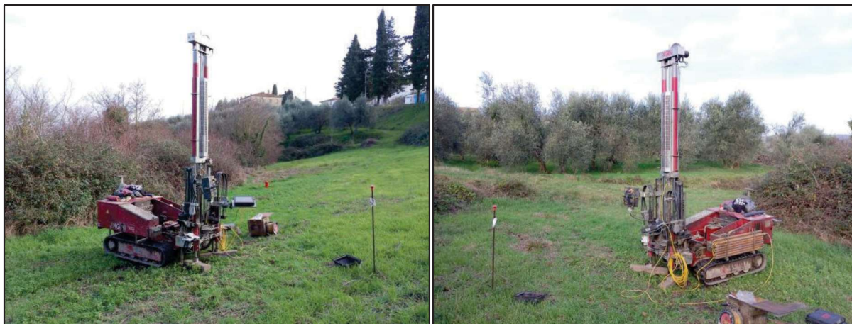
Fig 1: Prova penetrometrica statica con punta elettrica (CPTe) CPTe 03
