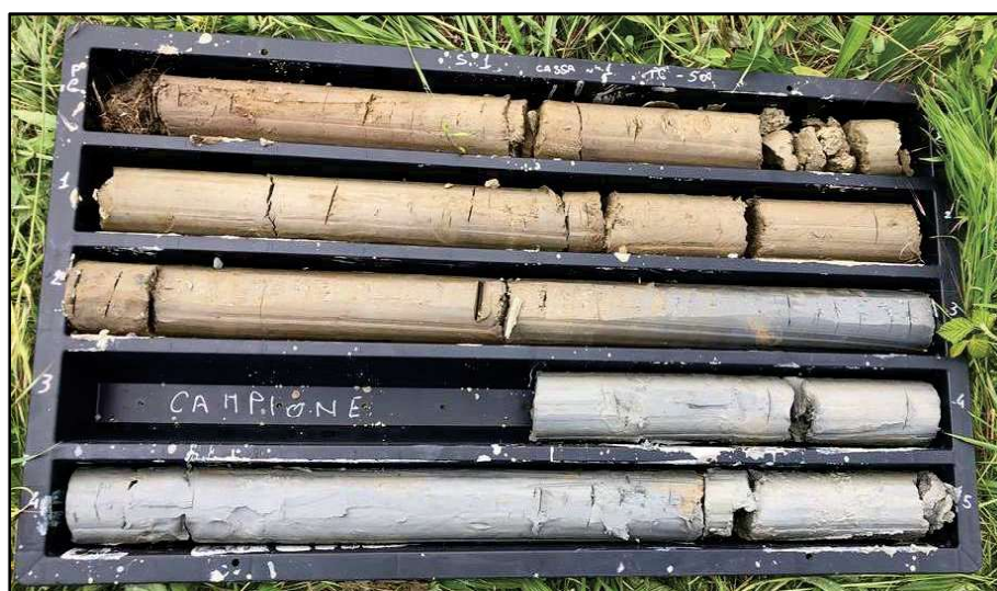
Figura 2: Cassetta n.1 - da 0.00 a 5.00 metri
