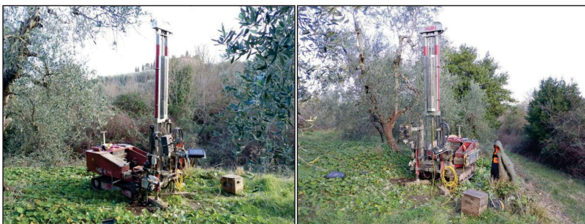
Fig 2: Prova penetrometrica statica con punta elettrica (CPTe) CPTe 05
