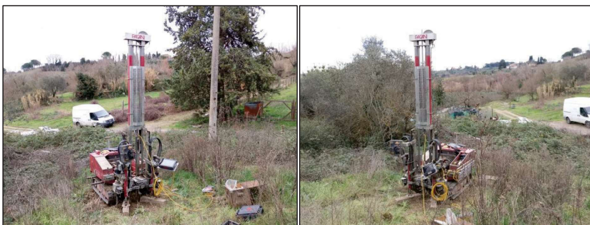
Fig 10: Prova penetrometrica statica con punta elettrica (CPTe) CPTe 22
